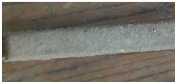
Figura 8. Probeta para hacer prueba de impacto en péndulo de Charpy. De acuerdo a la Norma ASTM E23 Fuente: Elaboración propia, 2018.
