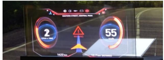
Fig. 2. Transparentes OLED mit der Möglichkeit zur optischen Überwachung des Displayinhaltes von der Panel-Rückseite
